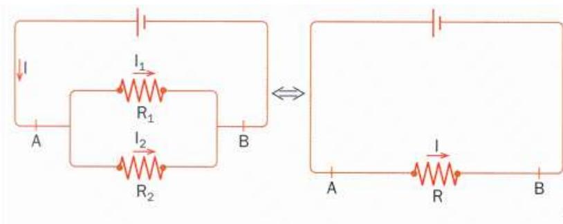
Ejemplo 1: calcula la resistencia equivalente en el siguiente circuito, sabiendo que la primera resistencia es de 10Ω y la segunda de 20Ω. ¿Qué intensidad pasa por el circuito si conectamos una batería de 30V?
